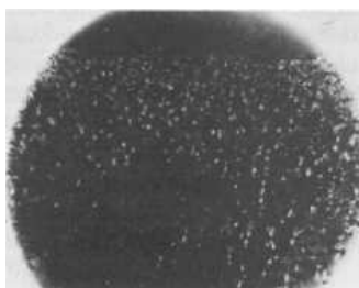
Abb. 10. Dasselbe Wasser nach 5 Durchgängen durch die Magnetvorrichtung. 200
