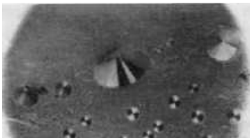
Abb. 17. Einen Tag alte scheibenförmige Kristalle mit Sekundärkristallisation, Entwicklung von Löchern im Zentrum, Auflösungsbeginn. 400
