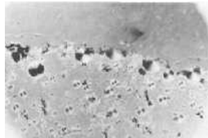
Abb. 8. Fläche mit verästelten Kristallen bedeckt. 200 Das gleiche Leitungswasser 1 Tag nach der Anbringung der Behandlungsvorrichtung. Nur 5 % CaCO_3 -Kristalle sitzen auf dem Substrat, 95% sind in der Form von gestreuten, nicht befestigten Kristallen zu erkennen. 400
